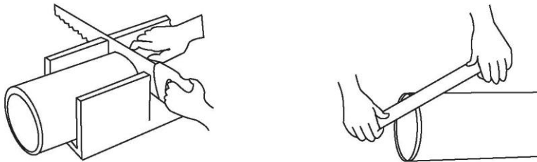
Obrázok 17: Skracovanie a úprava konca hladkej kanalizačnej rúry
