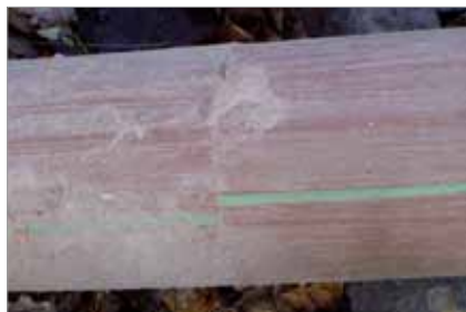
Obr. 1 Souvislá ochrana vnějšího povrchu potrubí. Svařování na tupo - GEROfit® R efekt.
