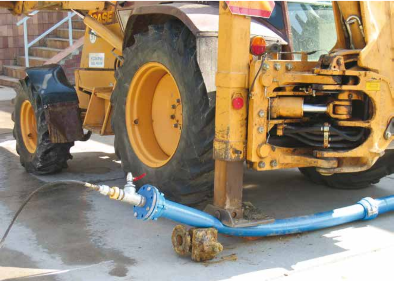
Ukázky z testování houževnatosti potrubí Mondial na různých vodárnách v rámci ČR.
