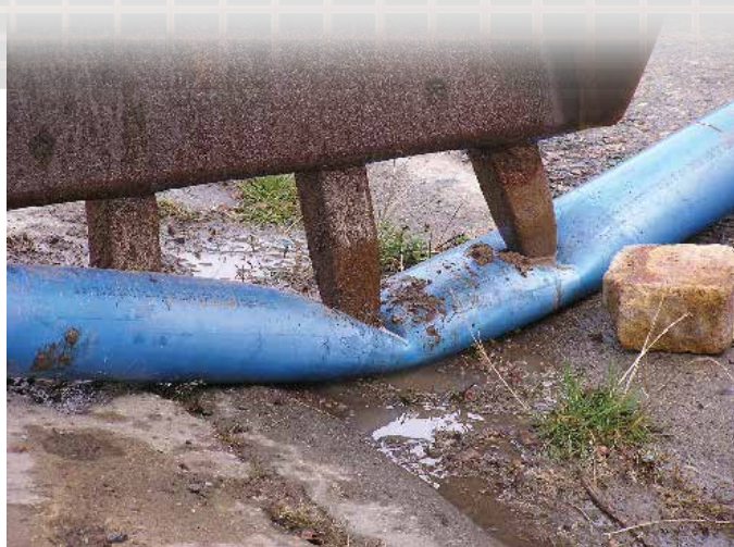
Molekulární orientace u potrubí Mondial výrazně zvýší houževnatost v porovnání s běžným potrubím z PVC-U
